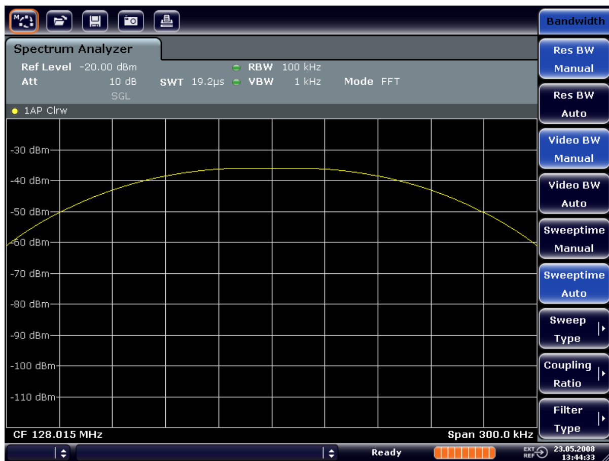
图 6-5: 测量两个等电平的射频正弦信号，分辨率带宽大于信号的频率间隔
