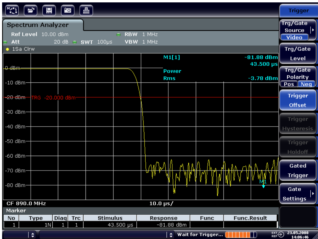
图 6-10: 高时间分辨率下显示的 GSM 突发信号的上升沿
